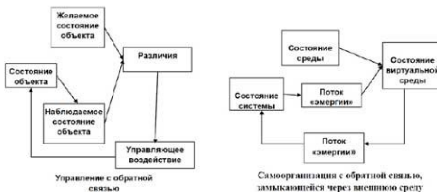
Рис. 7. КВП: а) Управление с обратной связью, б) Самоорганизация с обратной связью, замыкающейся через внешнюю среду
